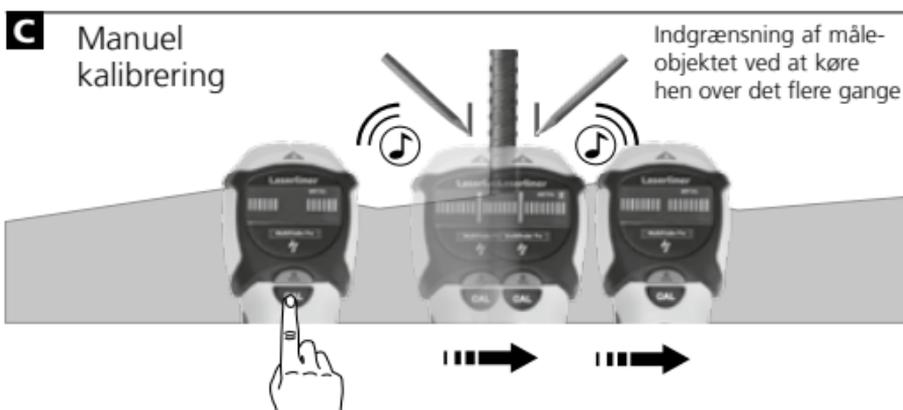
Tip 1: Mellem de to markeringer er midten af metalobjektet. På grund af den høje måle følsomhed kan tykke metalobjekters målte bredde virke bredere end den reelle bredde. Bevæg da atter apparatet hen over det fundne måleobjekt; se figur B. Herved kalibreres apparatet automatisk. Den manuelle kalibrering bør ske i nærheden af det sidst fundne sted; se figur C. Denne fremgangsmåde gentages efter behov.
