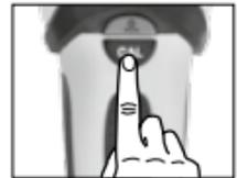
Se consigue la máxima sensibilidad del aparato sujetándolo en el aire durante la calibración. Esto puede ser muy útil puntualmente en mediciones de METAL y AC-SCAN.
