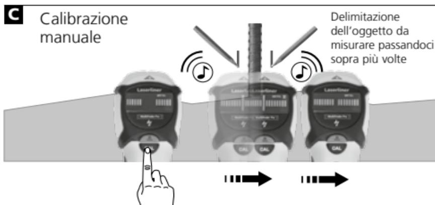
Suggerimento 1: Il centro dell'oggetto metallico si trova all'interno delle due marcature. A causa dell'alta sensibilità di misura, spesso oggetti metallici possono apparire più spessi di quanto lo siano in realtà. Muovere di nuovo l'apparecchio sull'oggetto da misurare trovato, vedi grafico B. L'apparecchio si calibra automaticamente. La calibrazione manuale deve avvenire nelle vicinanze del luogo trovato per ultimo, si veda il grafico C. Ripetere, se necessario, questo procedimento.
