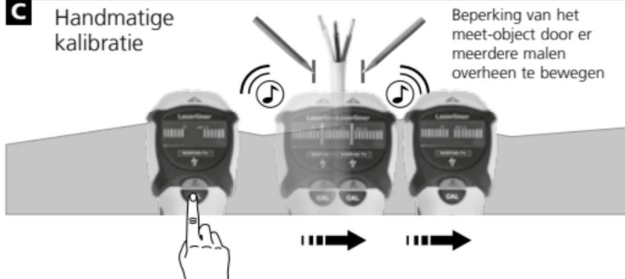
Tip 1: De handmatige kalibratie dient in de buurt van de als laatste gevonden positie te worden uitgevoerd, zie grafiek B/C. Herhaal deze werkstappen zo nodig.
