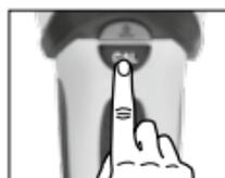
Die maximale Geräteempfindlichkeit wird erreicht, wenn das Gerät bei der Kalibrierung in die Luft gehalten wird. Dies kann bei METAL- und AC-SCAN-Messungen stellenweise sinnvoll sein.
