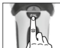
Tenendo l'apparecchio sospeso in aria durante la calibrazione, si ottiene la sua sensibilità massima. Ciò può essere localmente sensato durante misurazioni nelle modalità METAL-SCAN e AC-SCAN.
