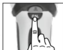
Pour atteindre la sensibilité maximale de l'instrument, maintenir l'instrument en l'air lors du calibrage. Cela peut être par endroit judicieux pour les mesures METAL et AC-SCAN.
