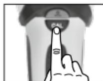
De maximale apparaatgevoeligheid wordt bereikt als het apparaat tijdens de kalibratie in de lucht wordt gehouden. Dit kan op bepaalde punten zinvol zijn bij METAL- en AC-SCAN-metingen.
