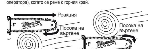
**Заклещване на веригата в прореза**
