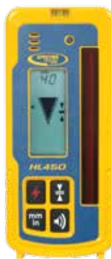
HL450 modtager med digital aflæsning til måling og visning af laserstråls placering
