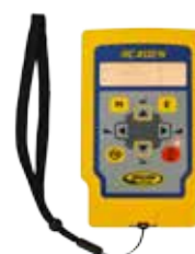
RC402N radiostyret fjernbetjening til alle opgaver
