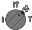
Position Vario-Lock zum Verstellen der Meißelposition In dieser Position rastet der Schlag-/Drehstopp-Schalter 11 nicht ein.
