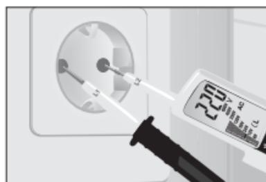
Tome el aparato básico (+) en la mano derecha y la segunda punta de comprobación (-) en la mano izquierda. Aplique las puntas de medición en los contactos a comprobar (p. ej. cables, enchufes, etc.).
