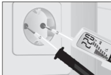
Вземете базовия уред (+) в дясната ръка, а втория тестов накрайник (-) в лявата ръка. Насочете измервателните накрайници до тестваните контакти (например проводник, щепселна розетка и др.).
