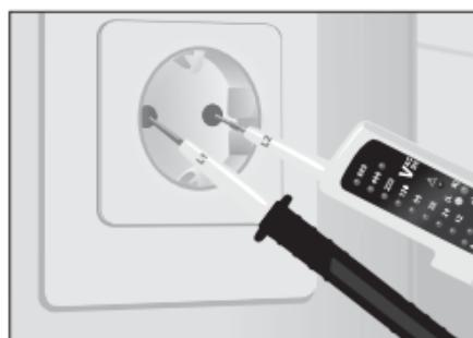
Võtke põhiseade (+) paremasse kätte ja teine kontrollotsak (-) vasakusse kätte. Pange mõõteotsakud vastu kontrollitavaid kontakti (nt juhe, pistikupesa vms).
