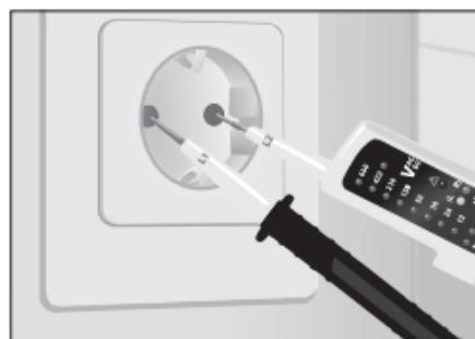
Man tager basisapparatet (+) i sin højre hånd og den 2. testspids (-) i sin venstre hånd. Herefter sætter man målespidserne til de kontakter, der skal testes (fx ledning, stikforbindelse, osv.).
