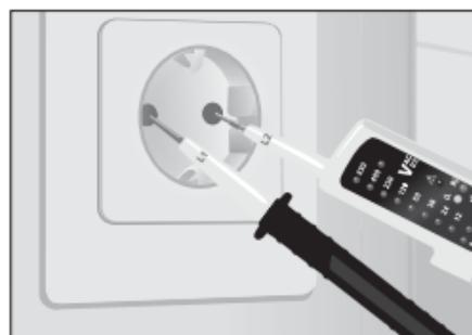
Nehmen Sie das Basisgerät (+) in die rechte Hand und die zweite Prüfspitze (-) in die linke Hand. Führen Sie nun die Meßspitzen an die zu prüfenden Kontakte (z.B. Leitung, Steckdose, etc.).
