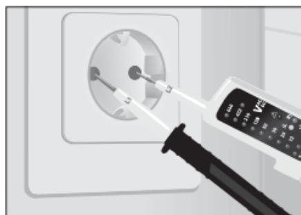
Πάρτε τη βασική συσκευή (+) στο δεξί χέρι και τη δεύτερη ακίδα ελέγχου (-) στο αριστερό χέρι. Φέρετε τώρα τις ακίδες μέτρησης στις προς έλεγχο επαφές (π.χ. καλώδιο, πρίζα, κτλ.).
