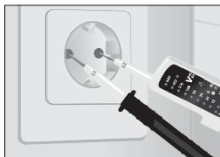
Luați aparatul de bază (+) în mâna dreaptă și al doilea vârf de verificare (-) în mâna stângă. Treceți acum cu vârfurile de măsură peste contactele de verificat (de ex. cablu, priză, etc.).
