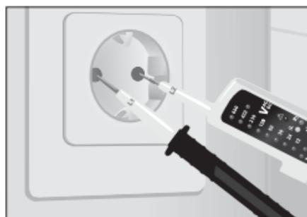
Ana cihazı (+) sağ elinize alınız ve ikinci kontrol ucunu (-) sol elinize. Ölçüm uçlarını kontrol etmek istediğiniz elektrik kontaklarına (ms. kablo, priz vs.) sürüneniz.
