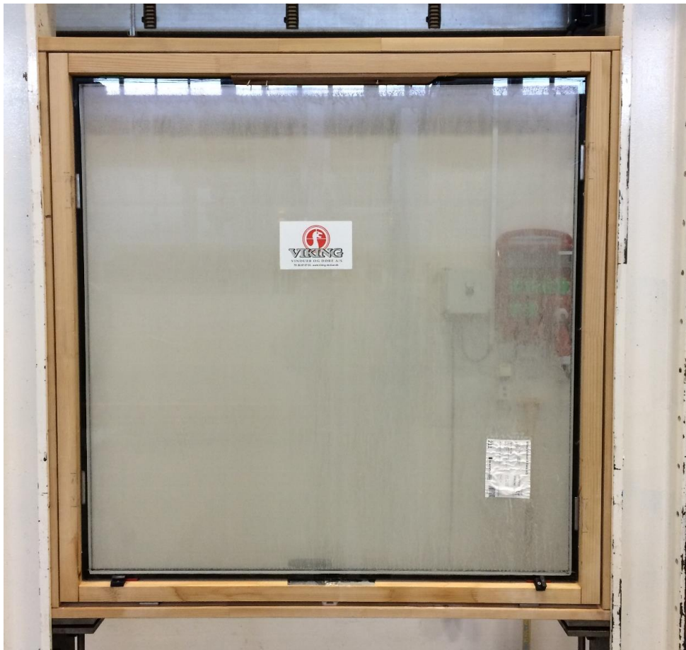
Vindue efter klimatest monteret i indbrudsstand og lister fjernet (slør på rude stammer fra aflejringer fra vand)
