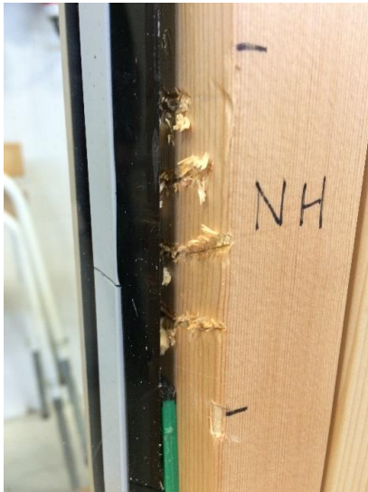
Figur 5 Træ flosset efter test.
