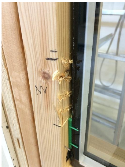
Figur 6 Træ flosset efter test.
