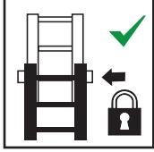
Stellen Sie sicher, dass die Stufen verriegelt sind
