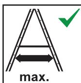
Stegen ska fällas ut helt när den ställs upp (beslag/stag ska vara helt utfällda/spända/låsta)
