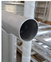
Rør uden forstærkningsring. Små hjul kan anvendes.
