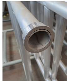
Rør med forstærkningsring. Store eller små hjul kan anvendes.
