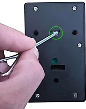
Wenn Sie das Schloss nach dem Einlegen der Batterien nicht in der Suchliste der App sehen, können Sie einen Hard-Reset des Schlosses durchführen. Drücken Sie den Reset-Knopf für 3 Sekunden, bis ein langer Piep-Ton ertönt. Nach dem langen Ton wird das Schloss in der XL Lock Manager App sichtbar.
