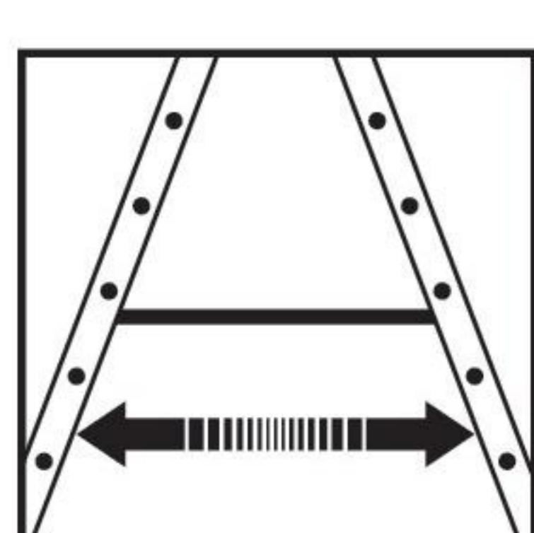
Die Leiter muss vor dem Gebrauch vollständig geöffnet werden (Verstrebungen / Bänder sollten vollständig geöffnet, festgedreht / verriegelt sein)
