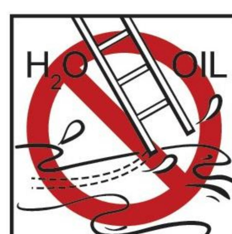
Stellen Sie sicher, dass der Boden frei von Verunreinigungen ist. Leiter darf nicht auf nassen oder rutschigem Untergrund aufgestellt werden.
