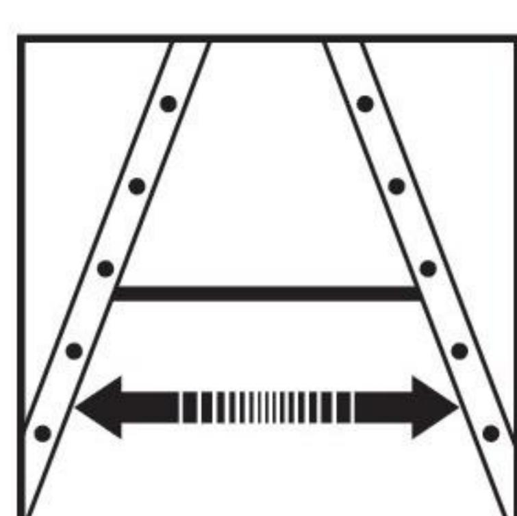
Stegen ska fällas ut helt när den ställs upp (beslag/stag ska vara helt utfällda/spända/låsta)
