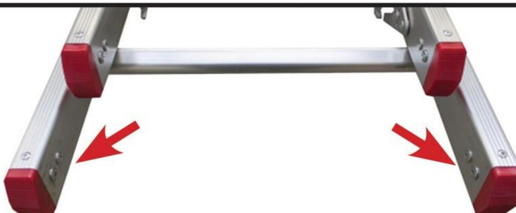
JUMBO Stigefod skal altid monteres i bunden af stigen og i de forborede huller. På stiger med flere led (f.eks. skyde-, hejse- og combistiger) skal stigefoden monteres på bundstigen - dvs. det bredeste stigeled.
