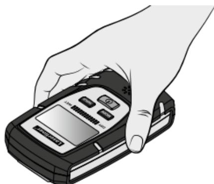
Die Sensor Pads vollständig auf das Messgut auflegen und das Gerät mit ca. 2,5 kg Druck auf die Messfläche drücken. **TIPP:** Anpressdruck mit einer Waage testen
