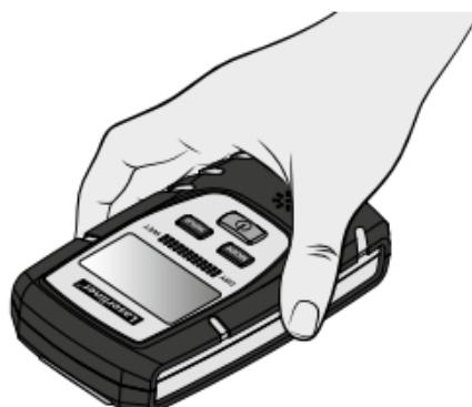
Styki z czujnikami położyć całkowicie na badanym materiale i docisnąć urządzenie do powierzchni pomiarowej, wywierając nacisk ok. 2,5 kg.
