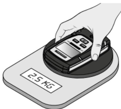
Poser entièrement les pastilles de détection et appuyer l'appareil contre la surface à mesurer en exerçant une pression d'env. 2,5 kg. **ASTUCE :** tester la pression d'appui en utilisant une balance
