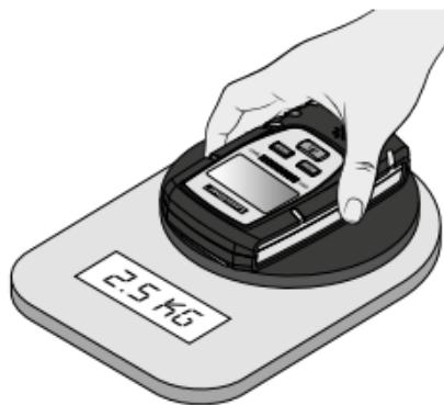
Plaats de sensorpads volledig op het te meten voorwerp en druk het apparaat met een kracht van ca. 2,5 kg op het meetoppervlak. **TIP:** test de aanpersdruk met een weegschaal
