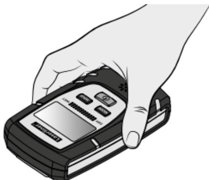
Sensorpuderne lægges helt an mod målematerialet, og apparatet presses ind mod målefonden med et tryk på ca. 2,5 kg. **TIP:** Test pressetrykket med en vægt
