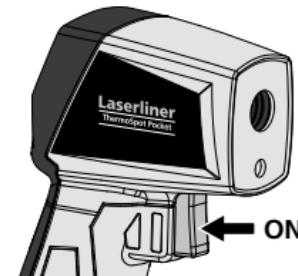
Das Gerät schaltet sich nach 30 Sekunden automatisch ab. Um das Gerät danach wieder einzuschalten, Taste erneut drücken.
