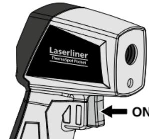
Laite kytkeytyy automaattisesti pois päältä, jos se on 30 s käyttämättömänä. Kytke laite uudelleen pääälle painiketta painamalla.
