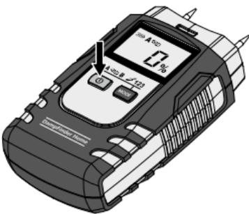
Apparatet slukker automatisk efter 3 minutter for at spare batteri. Herefter tænder man apparatet på ny ved at trykke på Tænd/Sluk-kontakten.
