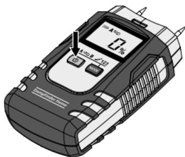
Paristojen säästämiseksi laite kytkeytyy pois päältä 3 min kuluttua. Kytke laitteeseen uudelleen virta ON/OFF-näppäimellä.
