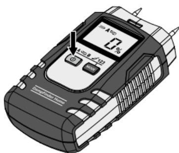
L'appareil s'éteint automatiquement après 3 minutes, ce qui permet d'économiser les piles. Pour rallumer l'appareil, appuyez de nouveau sur l'interrupteur marche-arrêt.
