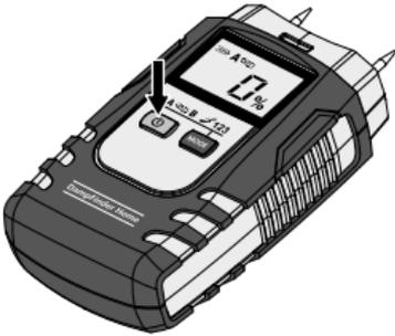
Cihaz 3 dakika sonra pillerin tasarrufu için otomatik olarak kapanır. Cihazı daha sonra tekrar açmak için Açma/Kapama şalterine yeniden basınız.
