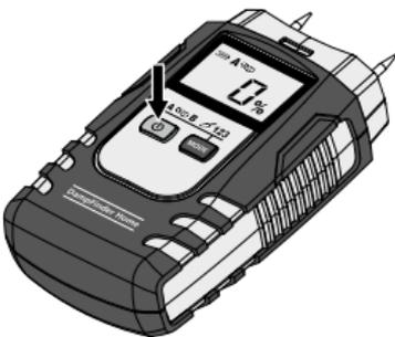
W celu oszczędzania baterii urządzenie wyłącza się automatycznie po upływie ok. 3 minut. Aby ponownie włączyć urządzenie, należy ponownie nacisnąć wyłącznik.
