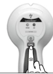
**!** Das Gerät und die Wand müssen bei der Kalibrierung im STUD-SCAN-Modus sowie während der gesamten Messungen in Kontakt bleiben. Ebenso sollte die Hand am Gerät bleiben.
