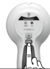
**!** Ved kalibreringen i STUD-SCAN-modus samt under hele målingen skal apparatet og veggen skal være i kontakt. Du bør også holde apparatet i hånden.
