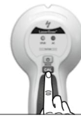
**!** Przyrząd i ściana muszą podczas kalibracji w trybie STUD-SCAN i podczas całego pomiaru pozostawać w kontakcie. Również ręka powinna pozostać na przyrządzie.
