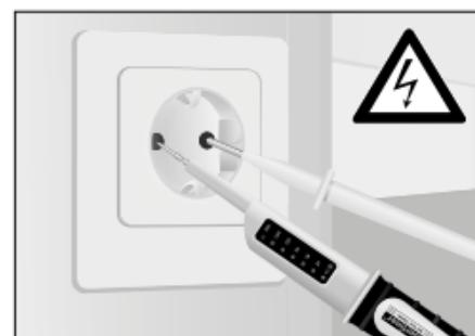
Якщо напруга  $\epsilon$ , загоряться усі світлодіоди в межах вимірюваної напруги, а також плюсовий та мінусовий СД-індикатори.
