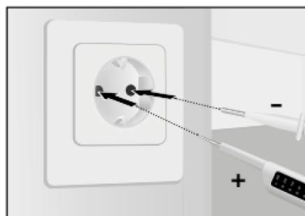
Wziąć urządzenie podstawowe (+) do prawej ręki, a drugą końcówkę pomiarową (-) do lewej ręki. Dotknąć teraz końcówką pomiarową sprawdzanych styków (np. przewód, gniazdko elektryczne itp.).
