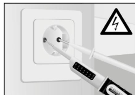
Jeżeli występuje napięcie, świecą wszystkie diody aż do zmierzonego napięcia oraz diody plusa i minusa.
