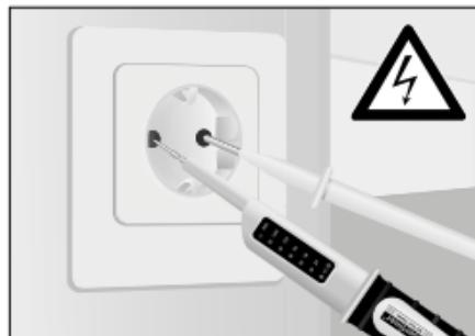
Võtke põhiseade (+) paremasse käte ja teine kontrollotsak (-) vasakusse käte. Pange mõõteotsakud vastu kontrollitavaid kontakti (nt juhe, pistikupesa vms).
