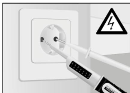
Luăti aparatul de bază (+) în mâna dreaptă și al doilea vârf de verificare (-) în mâna stângă. Treceți acum cu vârfurile de măsură peste contactele de verificat (de ex. cablu, priză, etc.).
