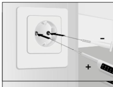
Ota laite (+) oikeaa käteen ja toinen mittauskärki (-) vasempaan käteen. Kosketa mittauskärjillä testattavaa kohdetta (esim. kaapeli, pistorasia jne.).
