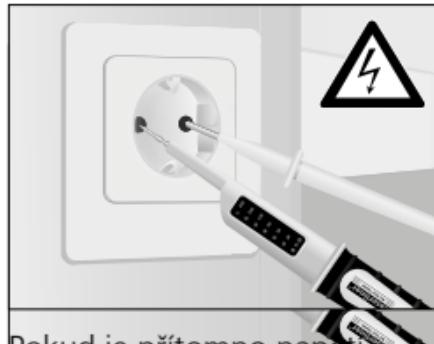
Vezměte základní přístroj (+) do pravé ruky a druhý zkoušební hrot (-) do levé ruky. Přiložte měřicí hroty ke zkoušeným kontaktům (např. kabelu, zásuvce, atd.).
