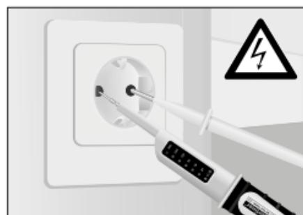
Prendre l'appareil de base (+) dans la main droite et la deuxième pointe de contrôle (-) dans la main gauche. Amener maintenant les pointes de mesure aux contacts à contrôler (par ex. ligne, prise, etc.).
