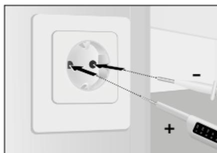
Pegue no aparelho de base (+) com a mão direita e a segunda ponta de verificação (-) na mão esquerda. Leve as pontas de medição aos contactos a verificar (p. ex. cabo, tomada, etc.).
