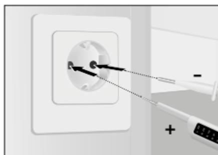
Вземете базовия уред (+) в дясната ръка, а втория тестов накрайник (-) в лявата ръка. Насочете измервателните накрайници до тестваните контакти (например проводник, щепселна розетка и др.).
