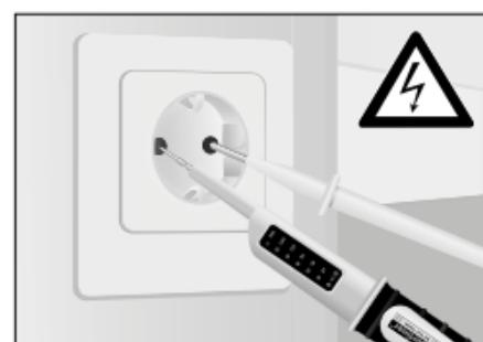
Hvis der findes spænding, lyser samtlige LED'er til og med den målte spænding samt plus- og minus-LED'en.
