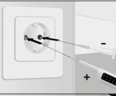
Ta basisapparatet (+) i den høyre hånd og den andre testspissen (-) i venstre hånd. Før nå målespissene til kontaktene som skal testes (f.eks. ledning, stikkontakt, etc.).
