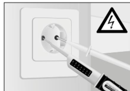
При наличии напряжения загорятся все светодиоды до того уровня напряжений, который был измерен, а также светодиоды „плюс“ и „минус“.
