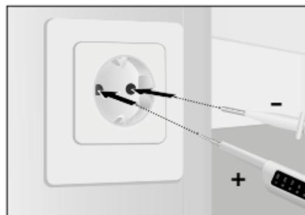
Взять в правую руку основной прибор (+), а в левую - второй измерительный наконечник (-). Подвести измерительные наконечники к тестируемым контактам (например, кабель, розетка и т.д.).
