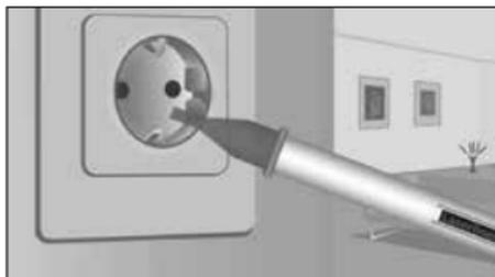
Ist Spannung vorhanden, leuchtet die Detektorspitze.
