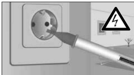
Hvis der findes en spænding, lyser detektorspidsen.
