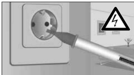
Se for detetada tensão, a ponta do detetor acende.
