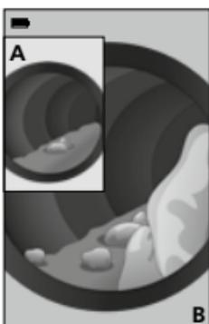
4. La photo de référence (A) sélectionnée apparaît à l'écran, la vue en direct (B) est visible en arrière-plan à des fins de comparaison.
