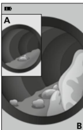
4. Det udvalgte referencebillede (A) vises på displayet, i baggrunden vises livebilledet (B) til sammenligning.
