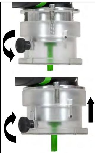
Løsn fingerskruen på beskyttelsesskærmen for at indstille fræsedybden. Skub den fjederbelastede ring på beskyttelsesskærmen så langt tilbage som muligt, indtil fugefræserklingen rager så langt ud som den ønskede fræsedybde. Hold ringen i denne position. Skub den løsnede hætte sammen med fingerskruen op til stoppet (i retning af værktøjet), og spænd fingerskruen.
