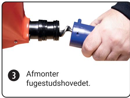
3 Afmonter fugestudshovedet.
