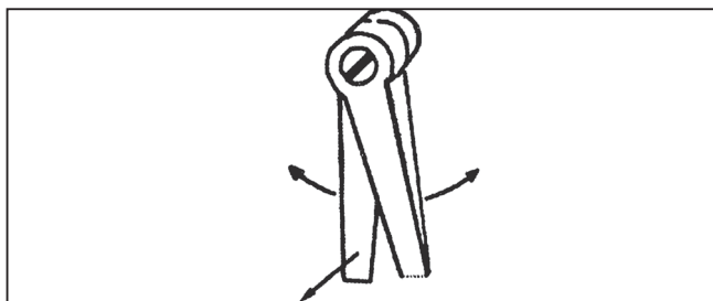
2.6 Przykręcić podstawę przykładni do stołu wyjściowego za pomocą dwóch śrub M8 z łbem 6-kątnym.
