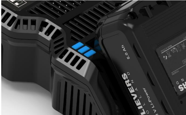
Figuur 13: Volledig opgeladen accu wordt nu druppel-geladen.
