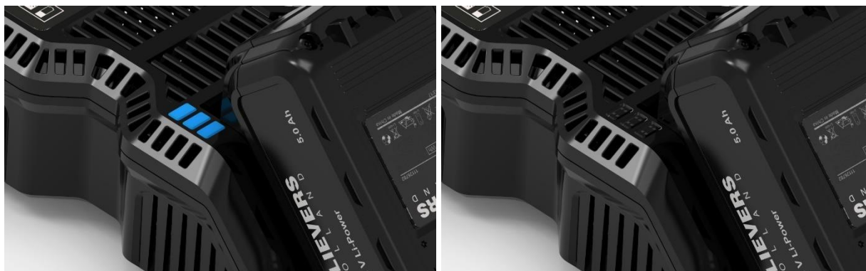
Figuur 8: Oplichten van acculader LED's bij aansluiten van voeding.
