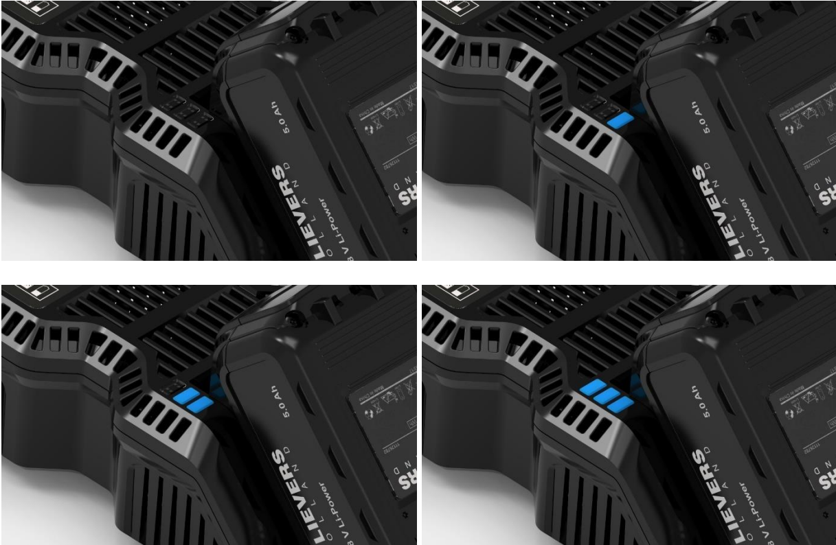
Abbildung 10: Aufladen eines vollständig leeren Akkus.
